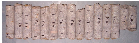
图 7 古月桥风化岩样端部切除前照片
